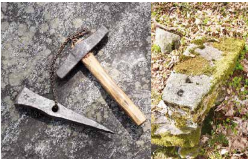
Fig. 1 Pietra a Corippo Ruöra con due tacche per il martellamento delle lame di falci e falcetti. L'incudine e il martello erano spesso collegati da una catena.
